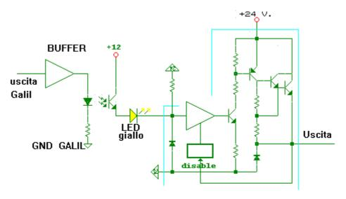
Tensione di uscita= Vsupply - 0.6 volt Corrente di uscita = 250 milliampere su tutte le ucite = 400 milliampere su max. 4 uscite
