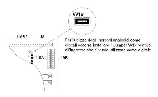
Se ad esempio volessi utilizzare l'ingresso analogico 1 come ingresso digitale, basterà inserire il jumper W11 e collegare l'ingresso digitale sul pin 1 di J19A1. Gli altri ingressi analogici potranno essere utilizzati come tali.
