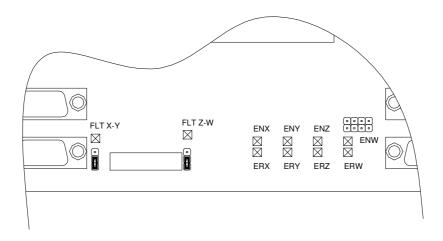
IL reset dei FAULT si ottiene utilizzando il pulsante presente sulla IOG ovvero spegnendo l'alimentazione della IOG.
