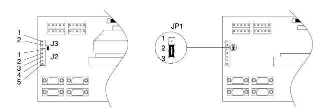
E' utile alimentare il DC/DC converter della IOG con alimentazione ausiliaria (o separata) qualora si utilizzino encoders ad alta risoluzione o cavi di connessione encoders molto lunghi. Si consiglia di effettuare la chiusura dei pins con jumper a saldare.
