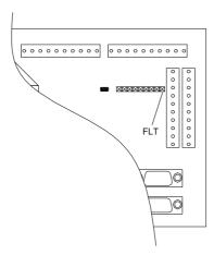
Il FAULT disabilita tutte le uscite, i leds gialli relativi alle uscite abilitate rimarranno però accesi permettendo con facilità di individuare l'uscita in corto circuito.
